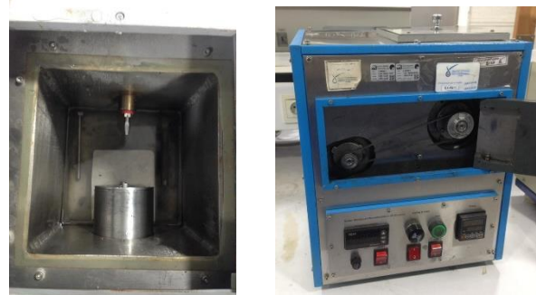
شکل ۲- نمایی از بیرون و داخل دستگاه مقاومت در برابر شستشوی گریس
