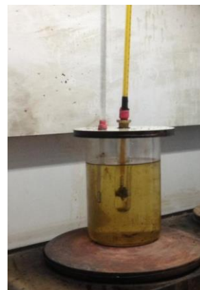
شکل ۱- شکل شماتیک و روش آزمون نقطه قطره‌ای شدن نقطه قطره‌ای شدن نشانگر پایداری حرارتی گریس می‌باشد. هنگامی که دمای گریس افزایش می‌یابد،
